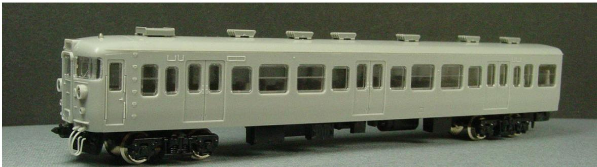
▲キットを組んだ状態／押込形通風器と客ドア手掛け、車体裾のドアコック位置などが115系の特徴です。
