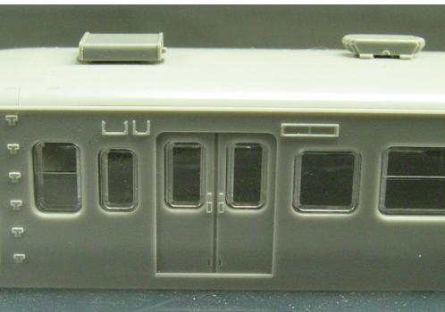
▲115系の特徴である客ドア「手掛け」はシャープなモールドで表現。室内側の手掛けの逃げも凸モールドで再現
