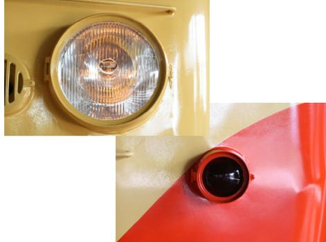
▲実車の前照灯と標識灯/写真は鉄道博物館所蔵のクハ167。前照灯・標識灯とも外側からランプ交換ができる大型のタイプです。
