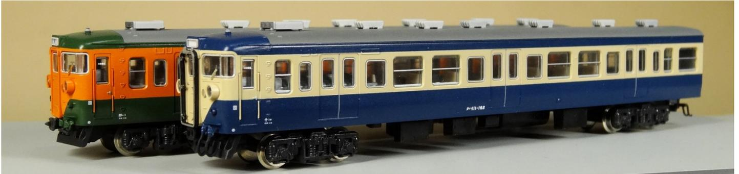
▲地上・耐雪型はグローブ型ベンチレーターの代わりに押込形通風器を装備している点が外観の特徴です。
