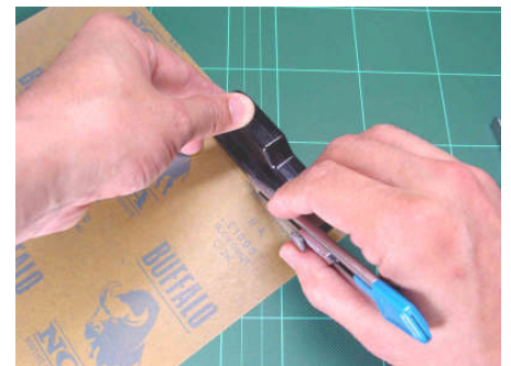
▲ペーパーの貼り付け (2) ホルダーを貼り付けてペーパーを切る。
