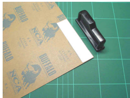
▲ペーパーの貼り付け (1) ペーパー裏面に両面テープを貼付。
