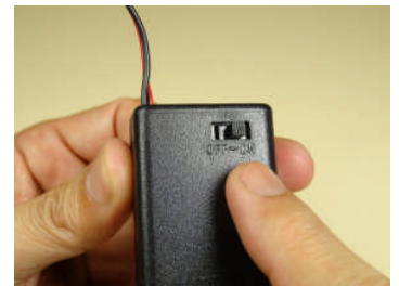
▲電池ボックスのスライドスイッチを「ON」側にします。
