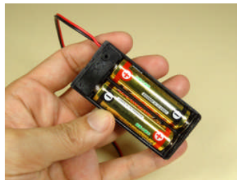
▲電池ボックス内に表示された向きに単3電池2本を入れます。
