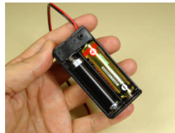
▲プラスチックに穴あけするときにはダミー電池を入れます。
