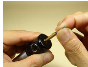
▲使用する径のドリル刃をドリルホルダーに差し込みます
