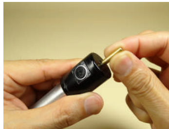
▲本体の回転軸にドリルホルダーをしっかり差し込みます。
