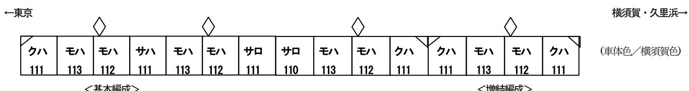
■1978年 113系・東海道線 基本11両編成+増結4両の15両編成<大船電車区>
