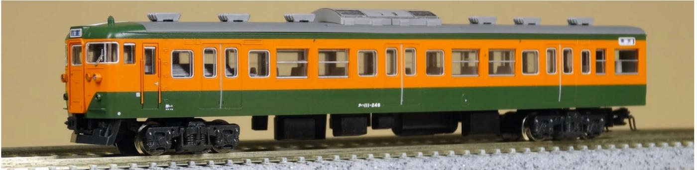
▲キット組立・塗装例/クハ111-0'番代(新製冷房車)は製造時より屋上に集中型クーラーを搭載し、前照灯をシールドビーム、客窓がユニットサッシに変更になった点が外観の特徴です。
